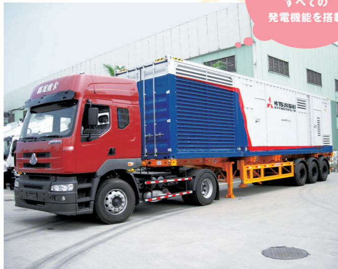
現地到着から発電まで24時間以内という「素早く移動、素早く設置、素早く発電」が特長のMEGANINJAは、1,500kWの発電出力を持つ。
