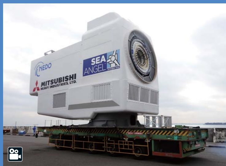
横浜製作所にて試験運転中の実証機「MWT100H」(写真右) 油圧ドライブトレインを採用したナセル(写真左)を搭載
