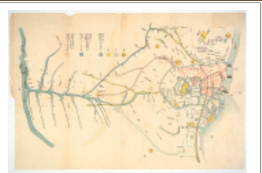
江戸の上水道 正徳（1711～1715年）末期の江戸の上水道の広がりを表した絵図。多摩川から引かれた水は途中で分水し、農業地帯にも供給された。江戸の街に入ると、網の目のように水道管が引かれ、配水されていた様子が分かる
