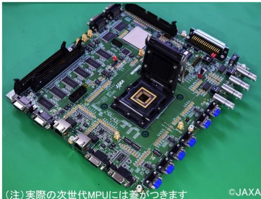
図2 評価基板(次世代 MPU 搭載状態)
