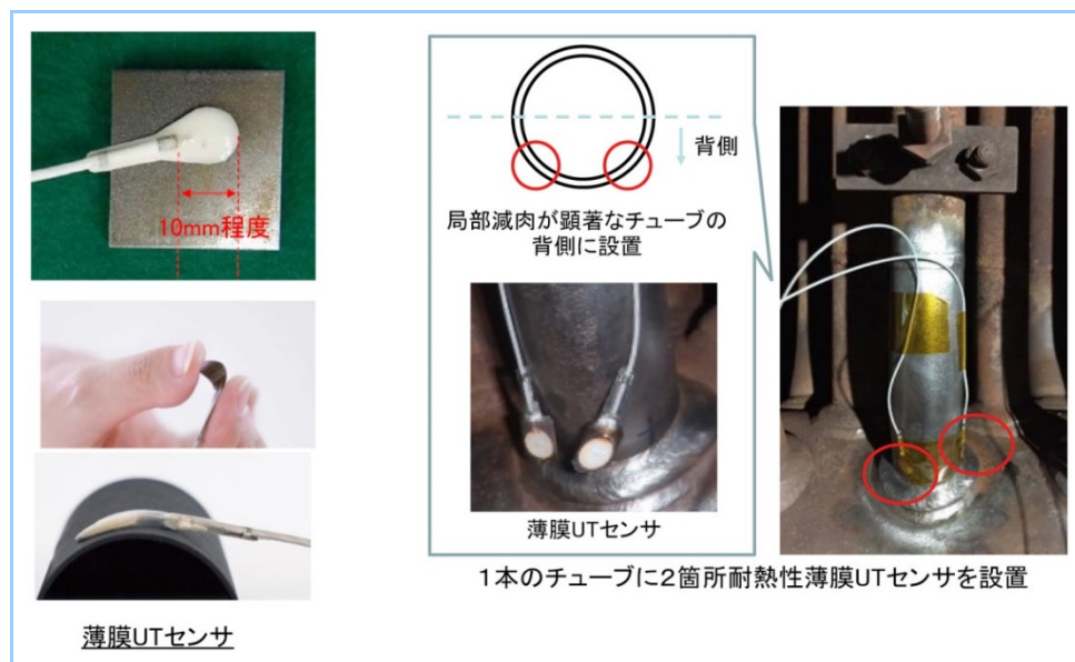
図5 耐熱性薄膜型 UT(薄膜 UT)センサの外観及び設置状況
