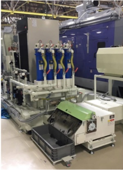
図7 ペーパーレスで環境に配慮した水溶性研削油対応専用クーラント装置
