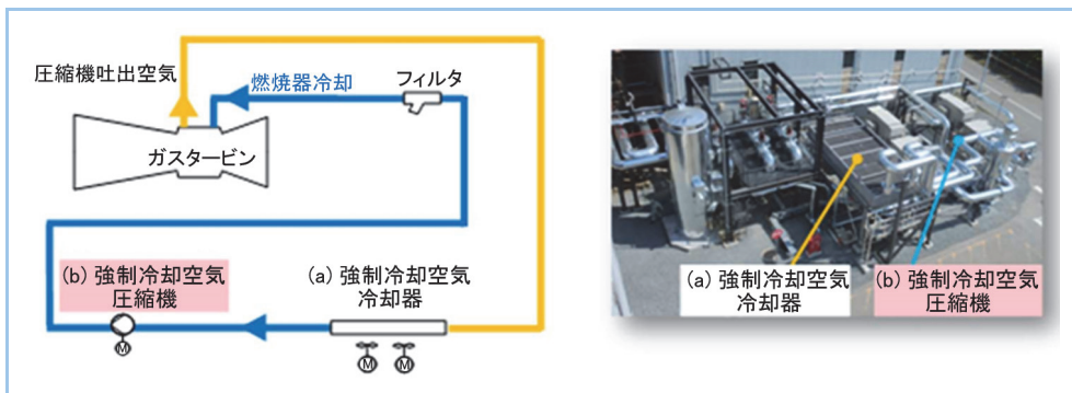
図8 T地点における強制空冷システム検証設備と系統
