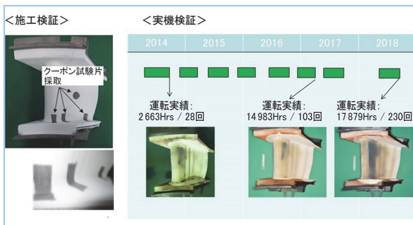
図 10 タービン1段静翼 超厚膜 TBC の検証状況
