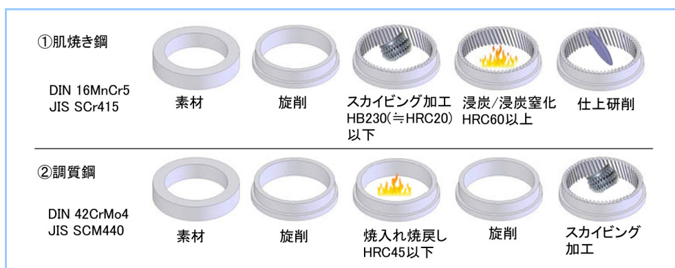
図3 内歯車の製造工程
