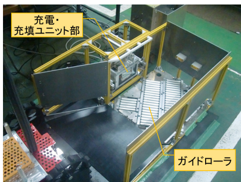
図5 ステーション外観
