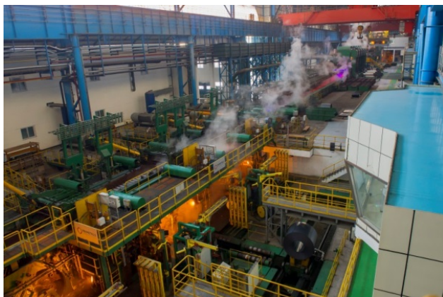
図6 ラミナー冷却, 高速剪断及びダウンコイル
