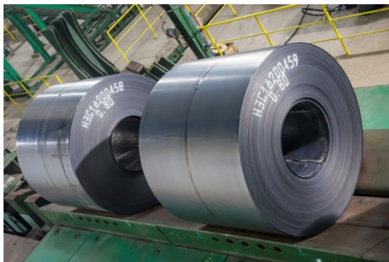
図8 0.8 mm 極薄熱間圧延コイル
