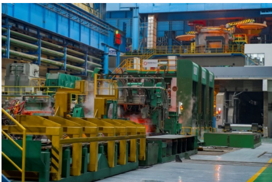
図3 ESP 連鋳機に直接連結された高圧下ミル
