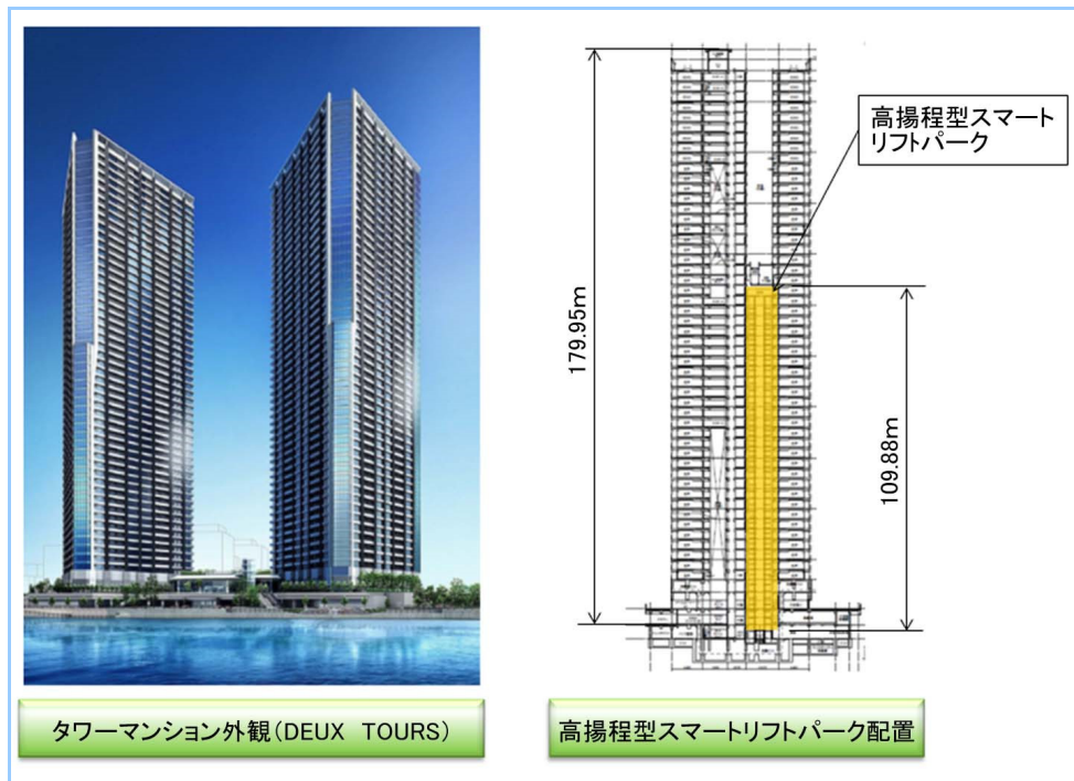
図1 タワーマンション外観および高揚程型スマートリフトパークの配置
