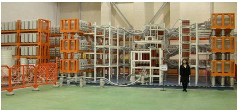
図2 雷電流発生装置外観図
