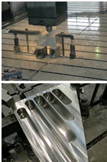
図5 RP溝加工の要素試験
