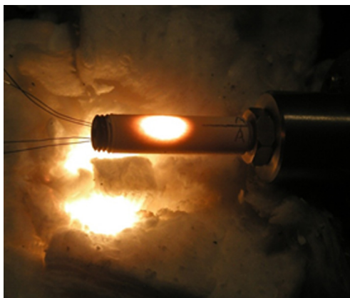
図9 先進 TBC のレーザー熱サイクル試験
