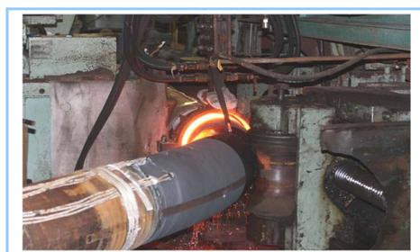
図6 HR6W大径管の曲げ加工状況
