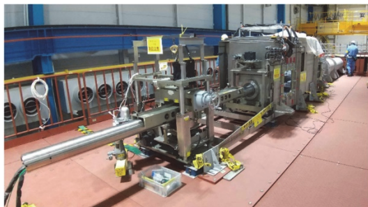
燃料デブリ試験的取出し装置 モックアップ試験状況
