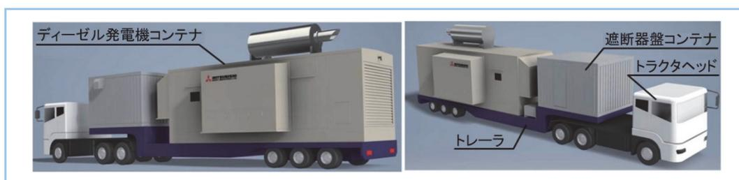
図7 車載式 空冷 DG の構造
