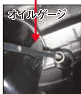
オイルゲージを左図のように引き抜き、FULLとLOWの間にオイル跡がない場合はオイル注入口よりオイルを補充してください。
