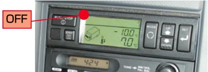
**8 商用電源(200Vブレーカー)スイッチを「OFF」にしてください。**
