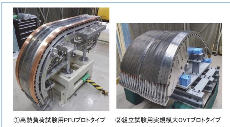
図5 ITER 向けダイバータプロトタイプ外観
