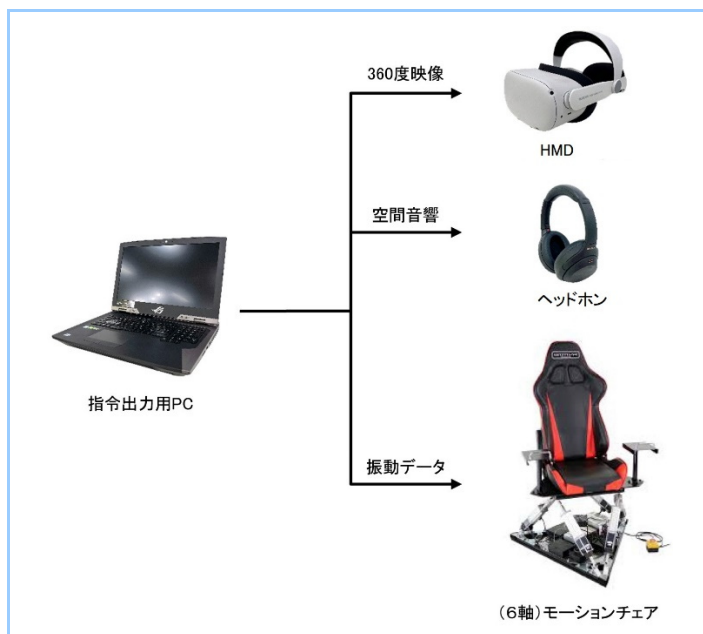
図1 乗り心地システムの構成図
