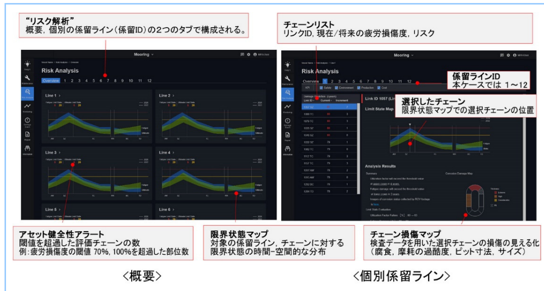
図8 係留設備のアセット健全性マネジメントダッシュボードの例
