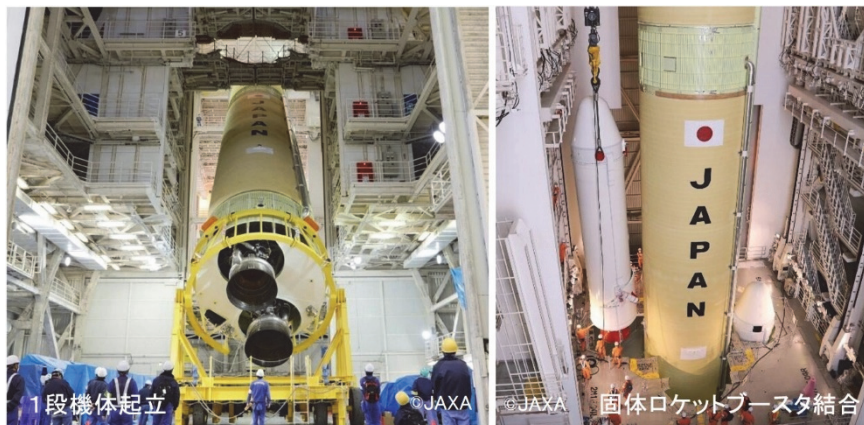
図9 試験機1号機全機組立て(@種子島宇宙センター)
