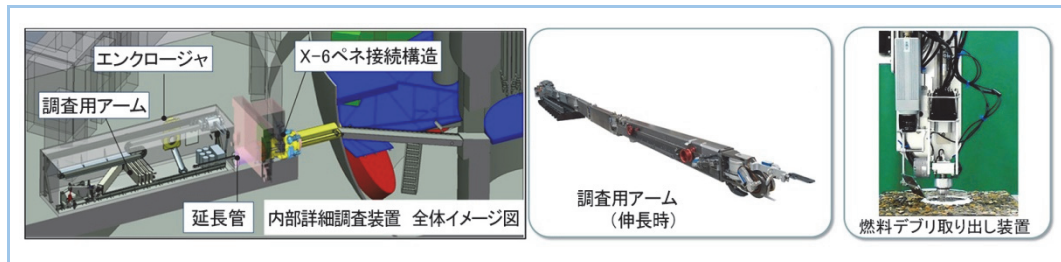
図 15 PCV 内部詳細調査装置外観及び試験的燃料デブリ取り出し装置
