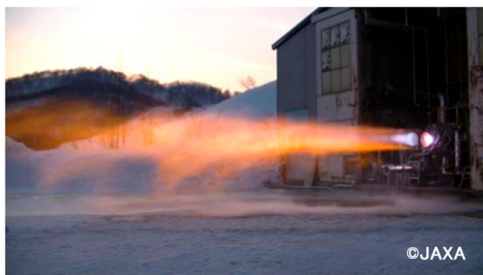
図 12 LE-5B-3 エンジン燃焼試験の様子
