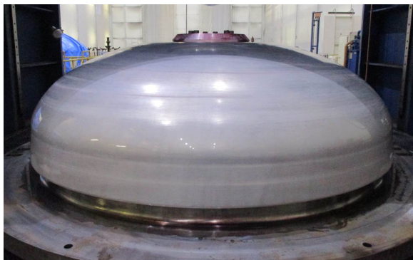
図4 H3 推進薬タンクドーム供試体
