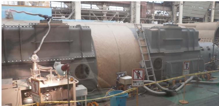
図4 高熱通過絶縁<sup>®</sup>の実機検証試験の状況
