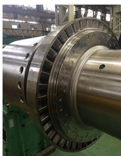
図4 調速段翼製造例
