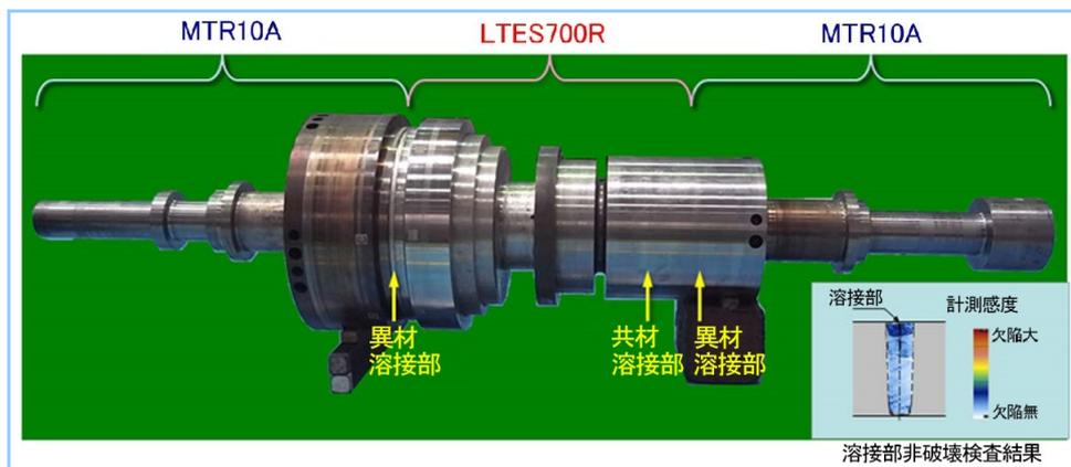
図3 溶接ロータ施工例及び非破壊検査例
