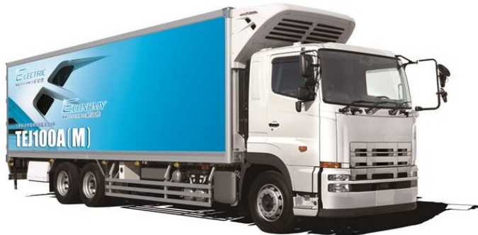
図4 全電動インバータ輸送用冷凍機 TEJ100AM 搭載のトラック
