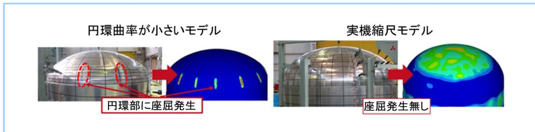
図5 内圧負荷試験(1/20縮尺)及び再現解析の結果
