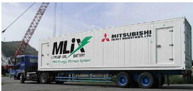
図2 トレーラで輸送中の ESS
