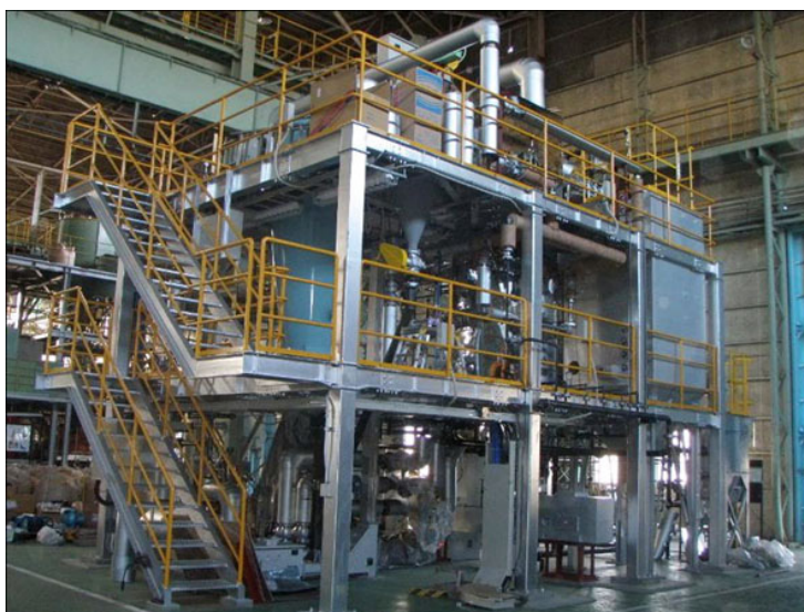
図3 10t/d褐炭乾燥ベンチスケール試験装置(PDU)
