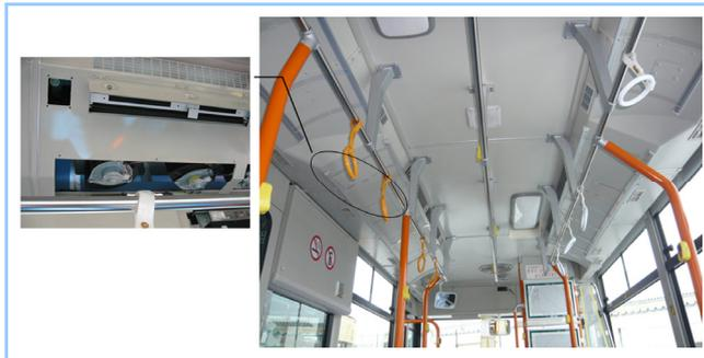
図2 エバポレータ搭載状況
