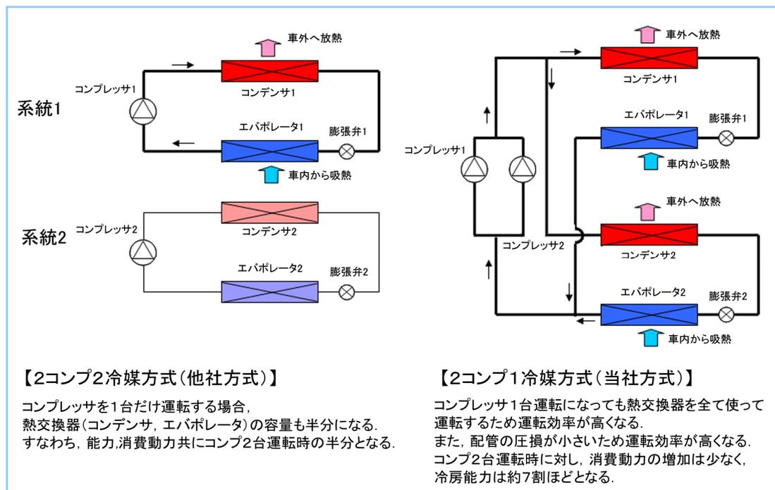
図1 2コンプ2冷媒方式と2コンプ1冷媒方式
