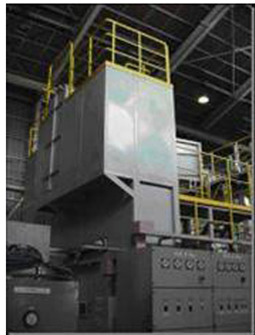
図5 熱過渡試験設備(SASS)の外観 SASSの外観を示す。ナトリウム漏えい対策のため、鉄板で覆われているのが特徴。
