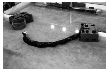
図6 開閉操作性確認 潮流を模擬した流水中での開閉操作性を確認した。写真は、対岸よりワイヤーロープを巻き取り、閉鎖動作を行っているところ。
