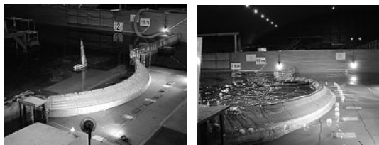
図4 実験状況 波浪中においても、漏水・越流が無く構造的に安定していることが確認された。
