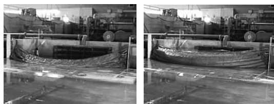
図7 陸閘型実験 左図：膜設置後、注水前：膜は垂れ下がり緩んでいる。右図：注水途中：膜は大きく膨らんで水圧を受け止め、止水している。
