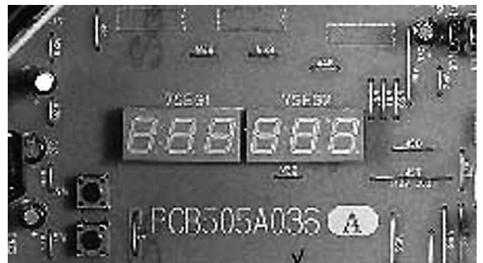
図3 室外コントローラ7セグ表示 室外コントロール基板上の7セグ表示にて圧縮機運転状態・各部温度・圧力・異常内容等様々なデータを確認できる。
