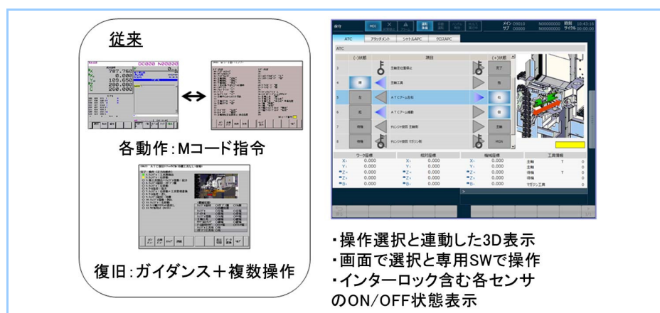
図6 従来機とM-VB25の復旧画面の比較(復旧手順)
