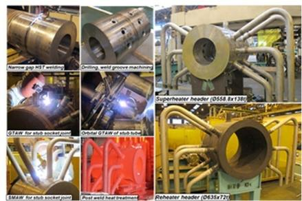
図9 A-USC ボイラの候補材開発試験
