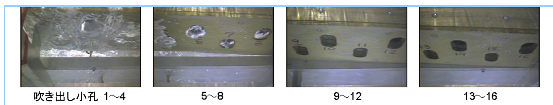
図7 小孔からの空気吹き出し状況写真(傾斜状態)
