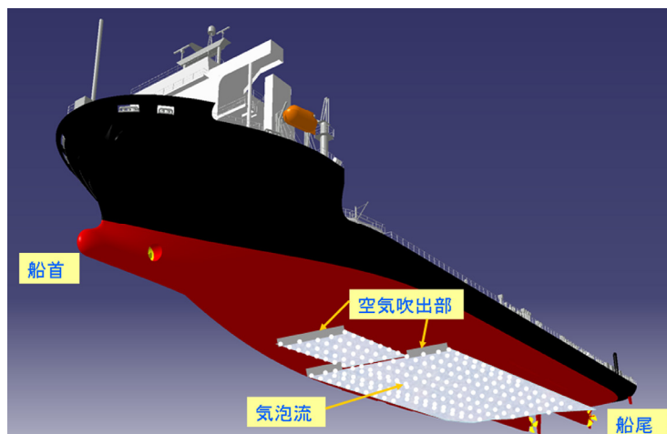
図1 空気潤滑法のイメージ
