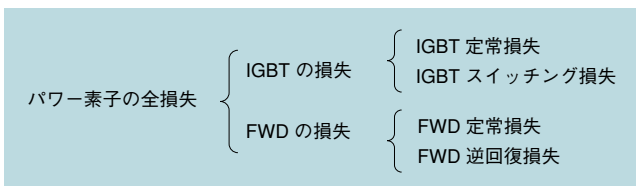
図3 パワー素子の全損失 パワー素子損失の要因は4種類に分けられる。
