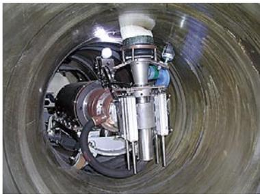
図7 管台内面除染装置試験状況
