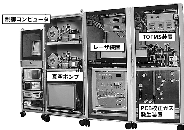
図1 排気中 PCB 濃度計 排気中 PCB 濃度計の機器構成を示す．
