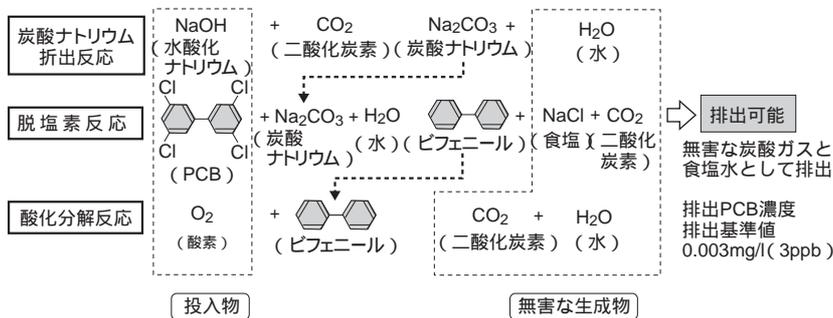
図2 水熱分解反応の原理 熱水中でPCBを、無害な水、食塩、二酸化炭素に分解する。
