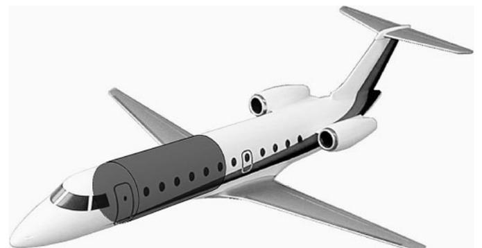
図2 実証試験供試体イメージ(航空機胴体構造)
