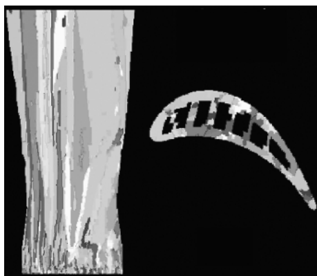
図3 結晶成長解析例 翼端から翼根にかけて結晶方位ごとに色が異なる結晶核が柱状晶へ選択成長していく様子が分かる。
