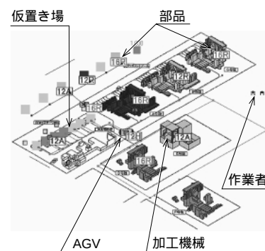
図12 エンジンクランクケース工場のモデリング例 自動搬送装置，加工機械と部品を模擬．
