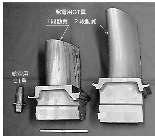
図1 発電用と航空用のガスタービン動翼 (一方方向凝固翼)
