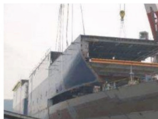
図1 工場で組み立てられているブロック(左写真)と搭載されているブロック(右写真)
