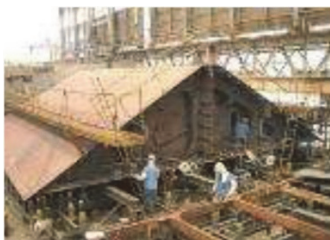
図1 工場で組み立てられているブロック(左写真)と搭載されているブロック(右写真)
