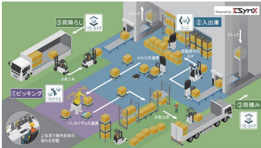
図3 荷降ろし～入出庫・ピッキング～荷積みまでの一連の荷役作業を自動化
