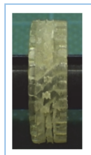
図5 AM 技術で製作したコイルホルダ
