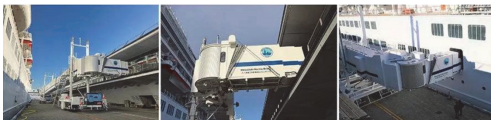
図1 自動運転機能付き自走式船用旅客搭乗橋
