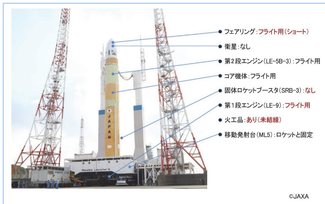
図3 試験機1号機 1段実機型タンクステージ燃焼試験 (3)
