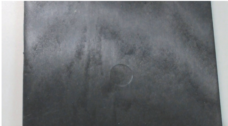
図7 リサイクル炭素繊維を用いた射出成形部品の外観品質
