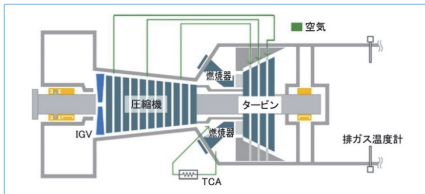
図3 当社ガスタービン機構 概念図
